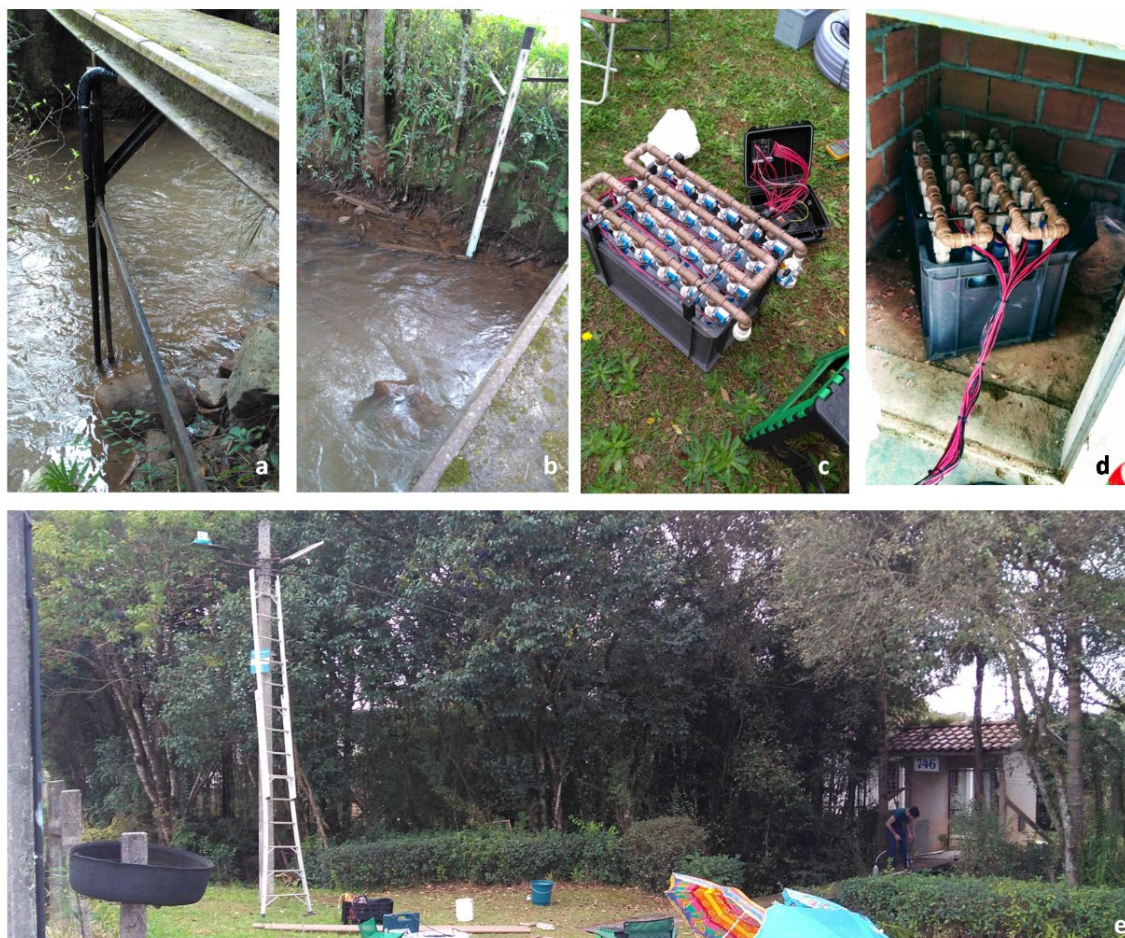
Figura 1A. Ponto de monitoramento BA1. (a) Estrutura de coleta de dados e amostras; (b) Régua para medição da altura da coluna d'água; (c) Amostrador automático; (d) Local de armazenamento do amostrador; (e) Local de monitoramento como um todo.
