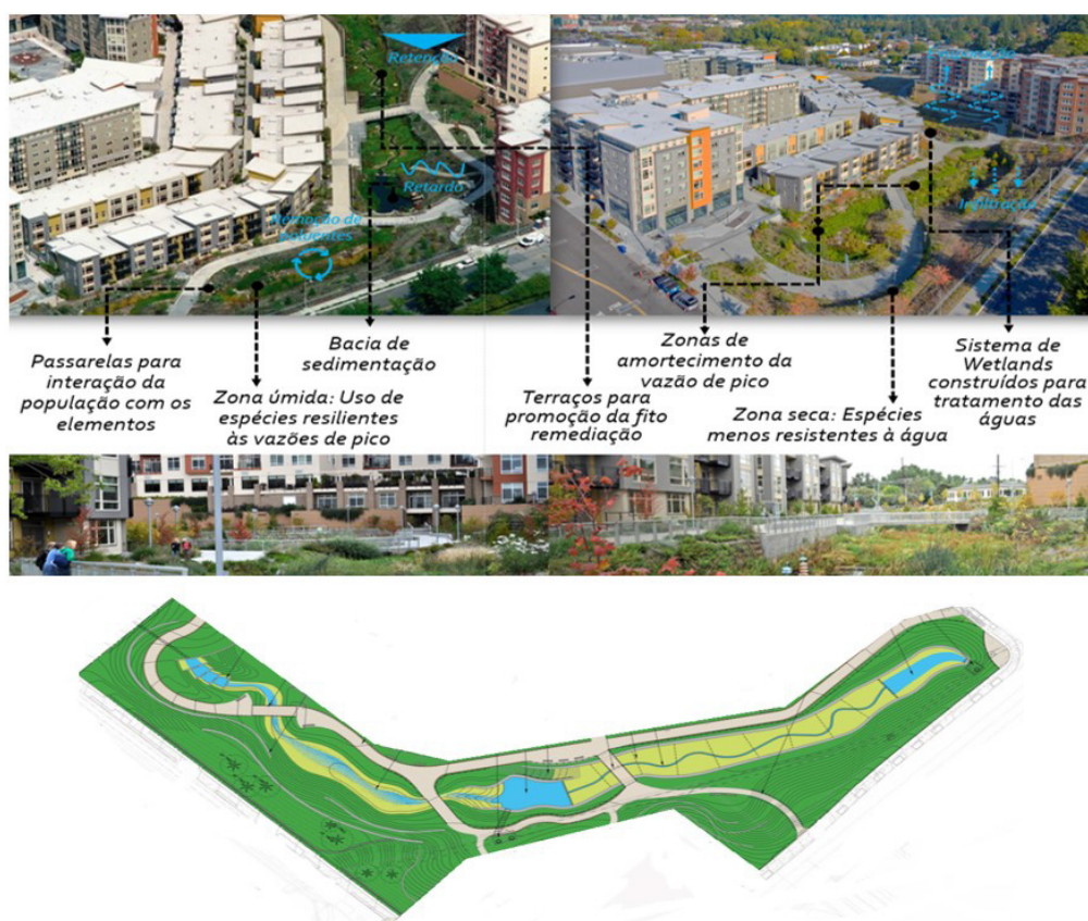
Figura 5 – Reservatório de tratamento das águas em Seattle no córrego Thornton.
